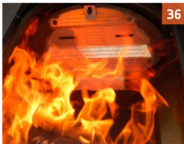
Bilde 36. Hvelvplate er brenn ren for sot etter 63 min. Dette er en indikasjon på at driftstemperatur er oppnådd i brennkammeret.
