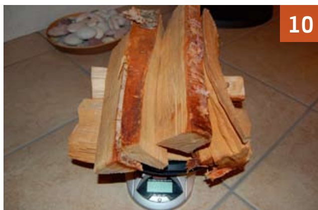
Bilde 10. Anbefalt vedmengde 3,5kg for denne ovnen. Vedmengde opptenning.
