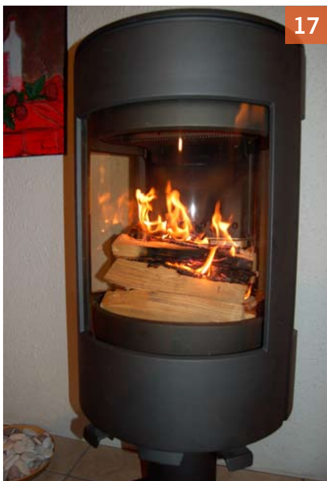
Bilde 17. Flammer etter 5 min. Ingen røyk i brennkammeret.
