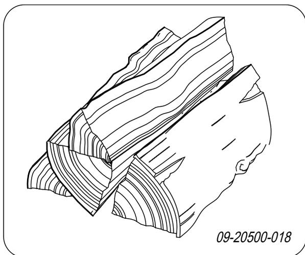
Ved kompakt ilegg forbrenner veden saktere fordi det kommer oksygen til bare noen av treskiene. Bruk kompakt ilegg hvis du skal fyre lengre.
